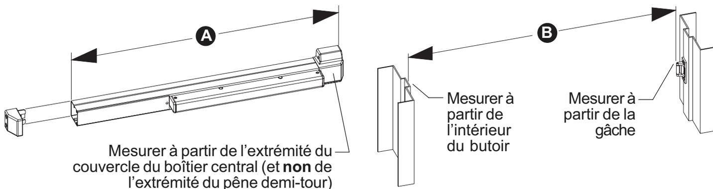
3.2. En cas de besoin, couper le mécanisme de façon à ce que **A** soit plus court que **B** d'au moins 1 po 1/2.
