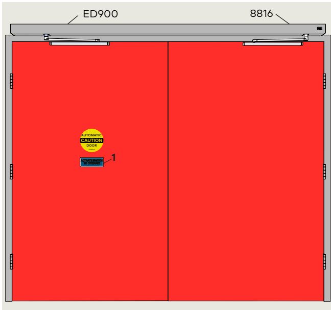
Fig. 10.2.1 Door pull side
